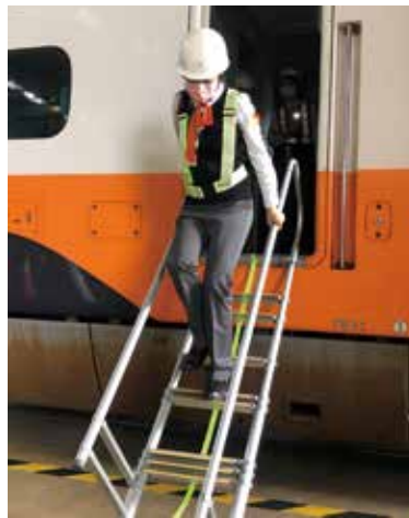
組員完成列車逃生梯架設後進行穩定度測試
