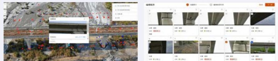
檢測資料搭配橋樑三維資訊，進行歷史照片細部檢視 自動生成巡檢報表，輔助數位化作業管理
