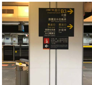
台北車站北上月台指引標誌更改為薄型 LED 燈箱 提升到站旅客對轉乘資訊之辨識度
