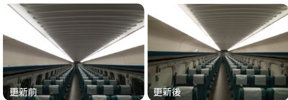
原 T8 燈管改以 4000K 之 LED 燈管取代
